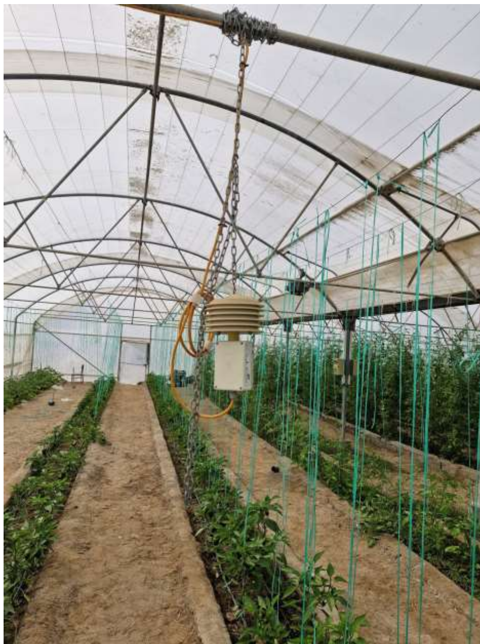
شکل ۸. سنسور دما و رطوبت نصب شده در اقلیم داخل گلخانه
